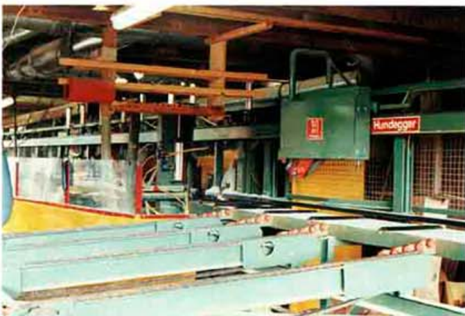
Bild 15: Vollautomatische CNC-gesteuerte Abbundanlage
