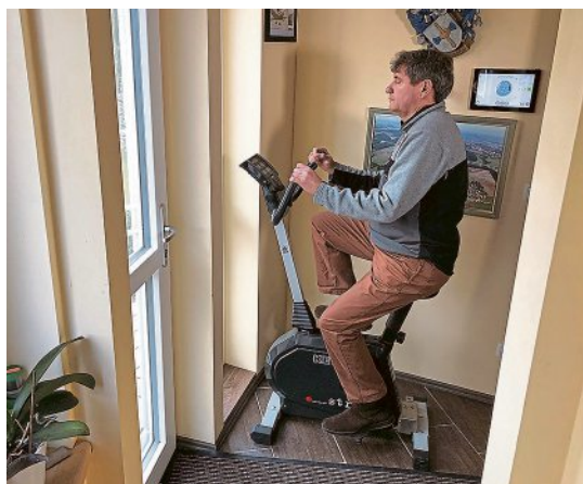
Für sportliche Bewohner gibt es ein Trimm-Dich-Rad, mit dem das Haus angetrieben werden kann – ansonsten übernimmt ein 180 Watt starker Motor die Arbeit.
