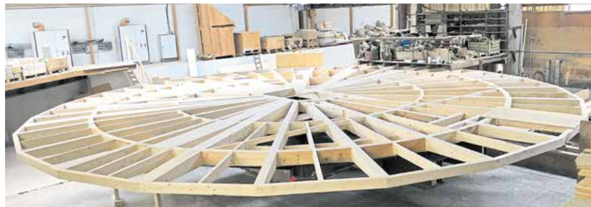
Der hölzerne Unterbau für das runde „DrehHaus“, das einen Innendurchmesser von elf Metern hat, wurde in der heimischen Werkhalle gefertigt.
